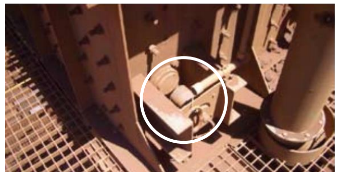
Mikroaaltokytkin suppilon tukosvahtina
