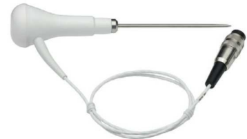
PX37L Ilma-/puikkoanturi · alue: -40 ... +150°C · 0.7 m suora kaapeli · termistori · EN13485 mukainen
