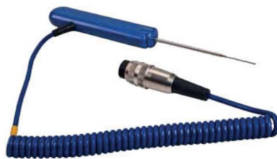
PT19L Ohuella anturipäällä · alue: -100 ... +250°C · 1.0 m kierrekaapeli · T-tyyppin termoparianturi
